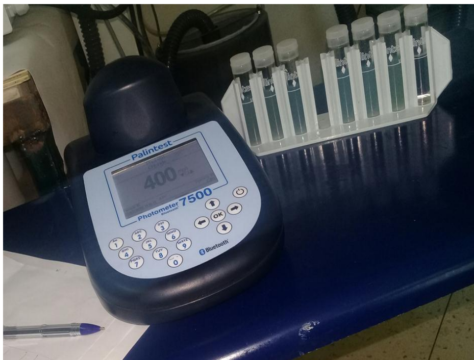
Figure 34 : Photomètre Palintest 7500 (mesure des Chlorures).
