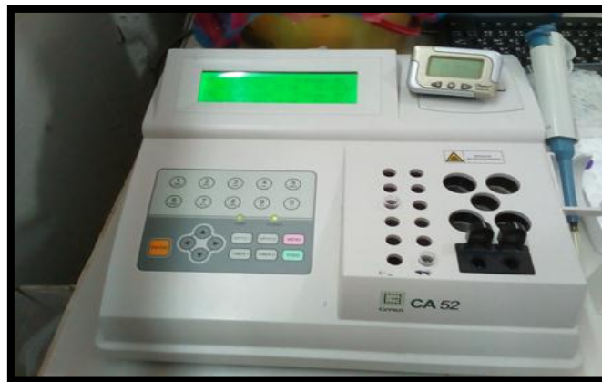
Figure N°21 : Evaluation de l'activité anticoagulante par une coagulomètre
