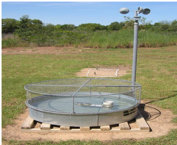
Figure. II.9- Bac d'évaporation de catégorie A équipé d'une station météorologique et d'une cage de protection. (Fr.wikipedia.org/wiki/Bac_d%27%C3%A9vaporation)
