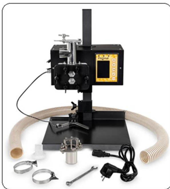
Figure 11: Doseuse à miel polyvalente.
