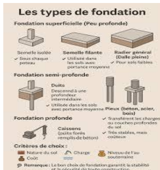
Figure I-10 : les type de fondation.
