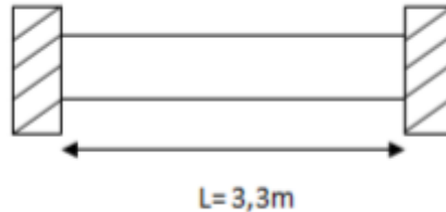
Figure III. 3.La poutre de palière.
