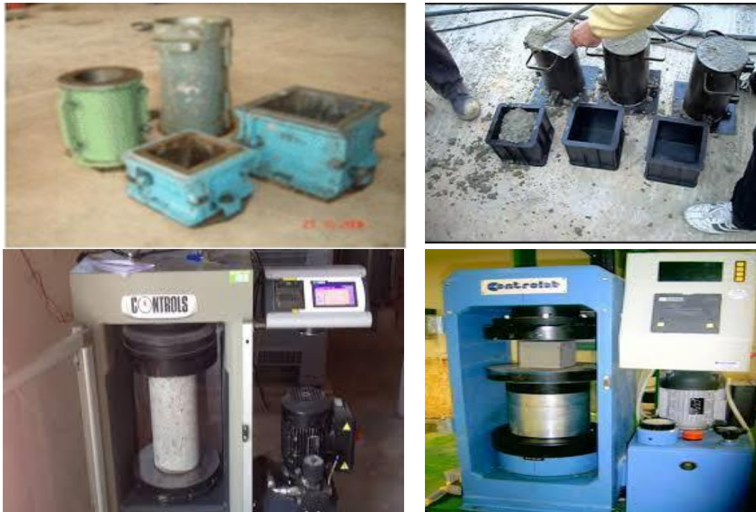
Figure I.16 : Mesures de la résistance en compression d'un béton
