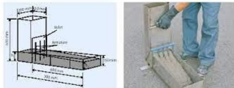
Figure I.26: Essai la boîte en L de béton autoplaçant
