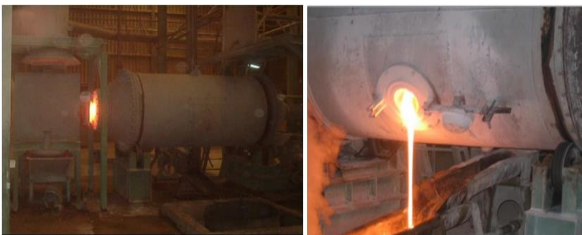
Figure II.16 : Le processus de fusion des frites
