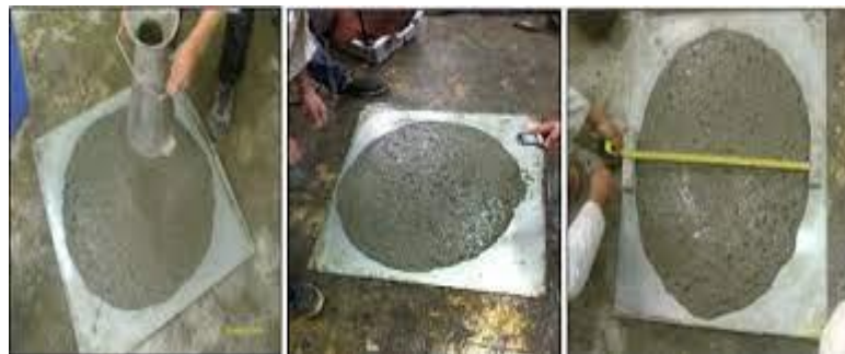
Figure I.25: Essai d'étalement de béton autoplaçant
