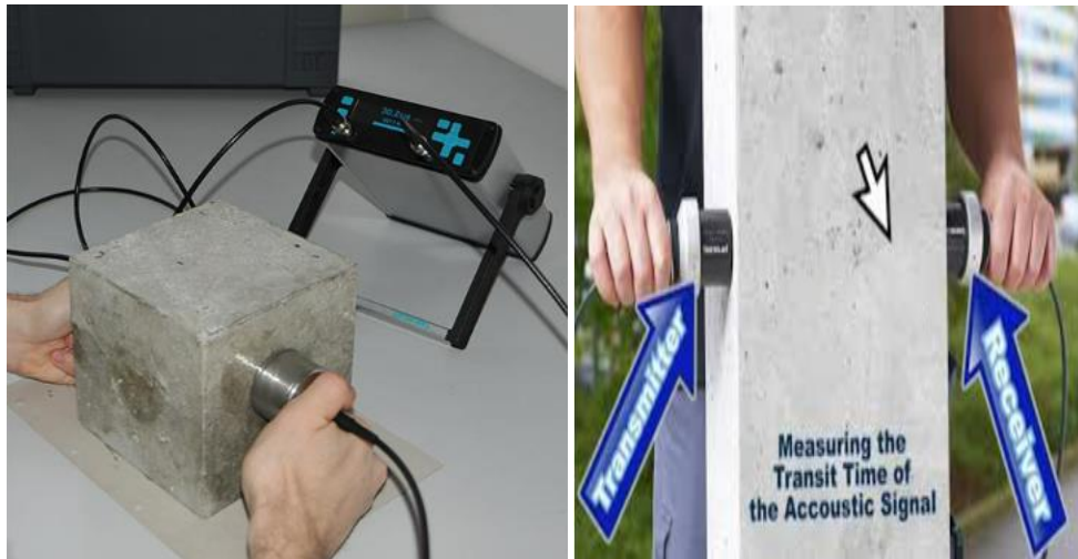
Figure I.23: Essai ultrasonique sur éprouvette cubique et sur poteau
