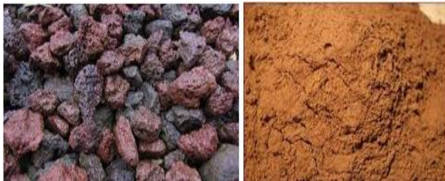
Figure I.4 : Pouzzolane naturelle avant et après broyage
