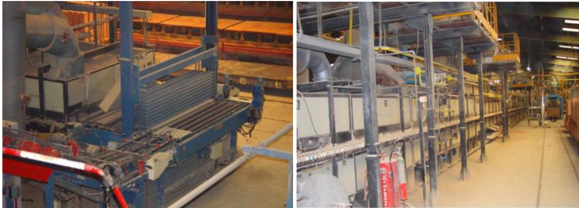
Figure II.20 : Four à rouleau pour cuisson biscuit
