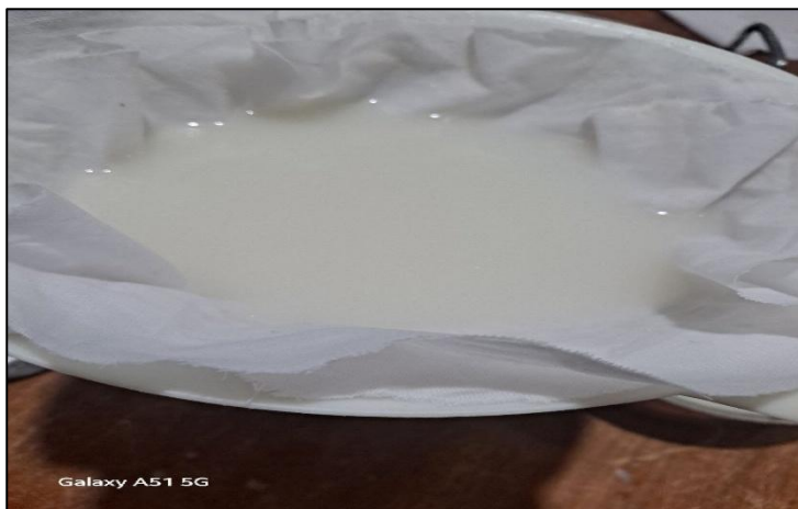
Photo IV.15 : Filtration du mélange : obtention d'un filtrat clair contenant l'amidon en suspension .
