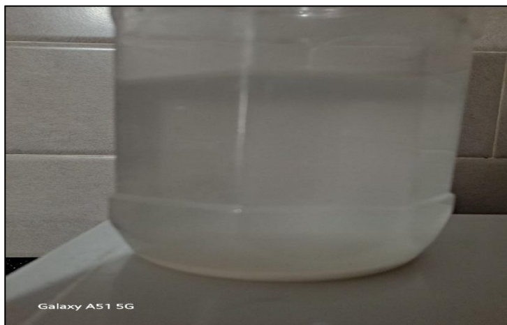
Photo IV.16 : Décantation du filtrat : formation d'un dépôt blanc d'amidon au fond du bécher après 30 minutes de repos .
