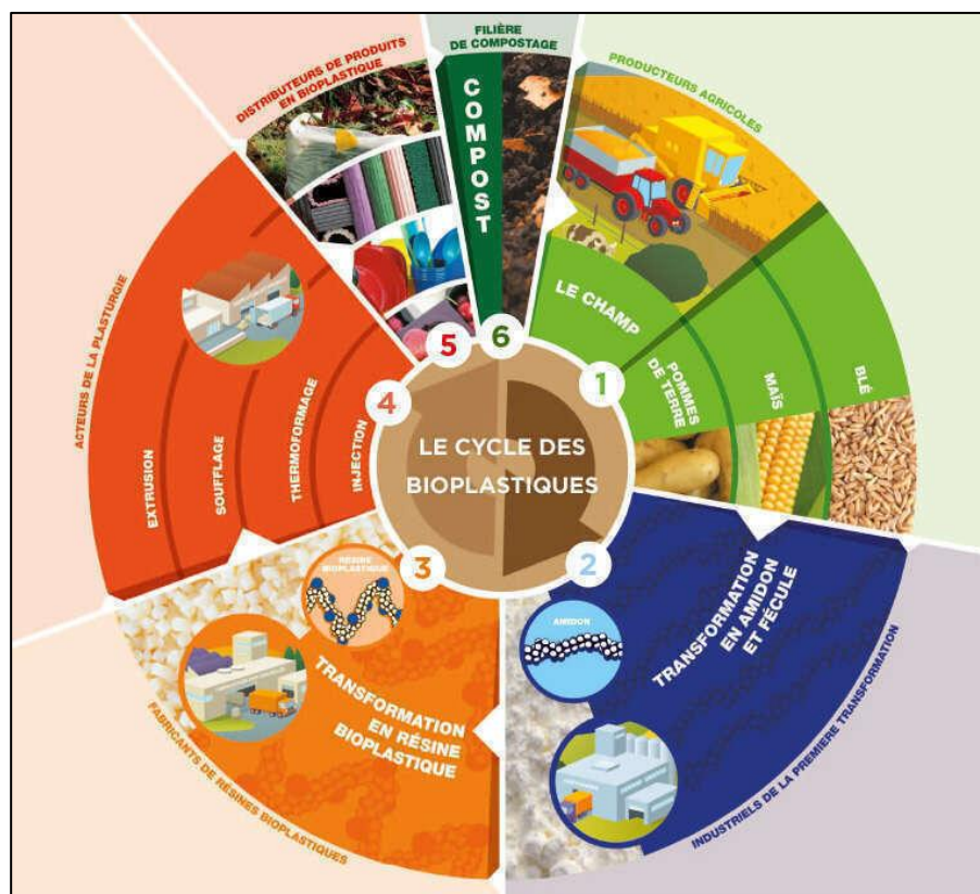
Figure III.13 : Les 6 étapes de économie circulaire de de plastiques biosourcés, biodégradables et compostables, issue de l'amidon. ( www.afcb-asso.org )
