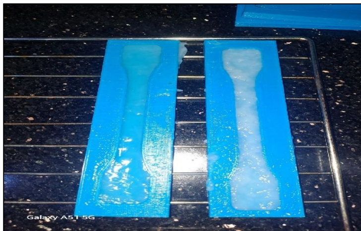
Photo IV.20 : Moulage et séchage des films d'amidon plastifiés : obtention de films après démoulage.
