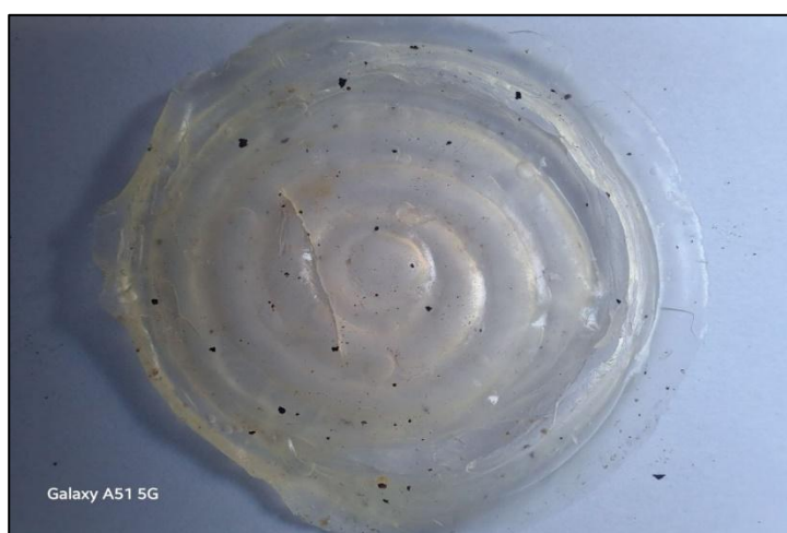
Photo V.23 : Film B3 :aspect continu et lisse, correspondant à la formulation contenant 0,7 g de NaOH.
