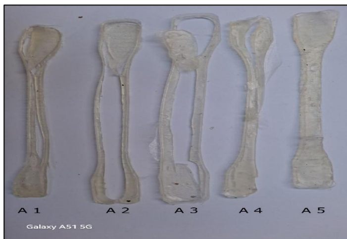
Photo V.21 : Aspect visuel des films d'amidon plastifiés au glycérol selon différentes formulations (A1 à A5) .
