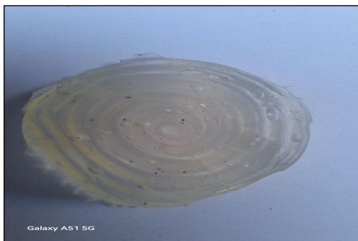
Photo V.24 : Film C3 traité avec 3 mL de HCl 0,1 M.
