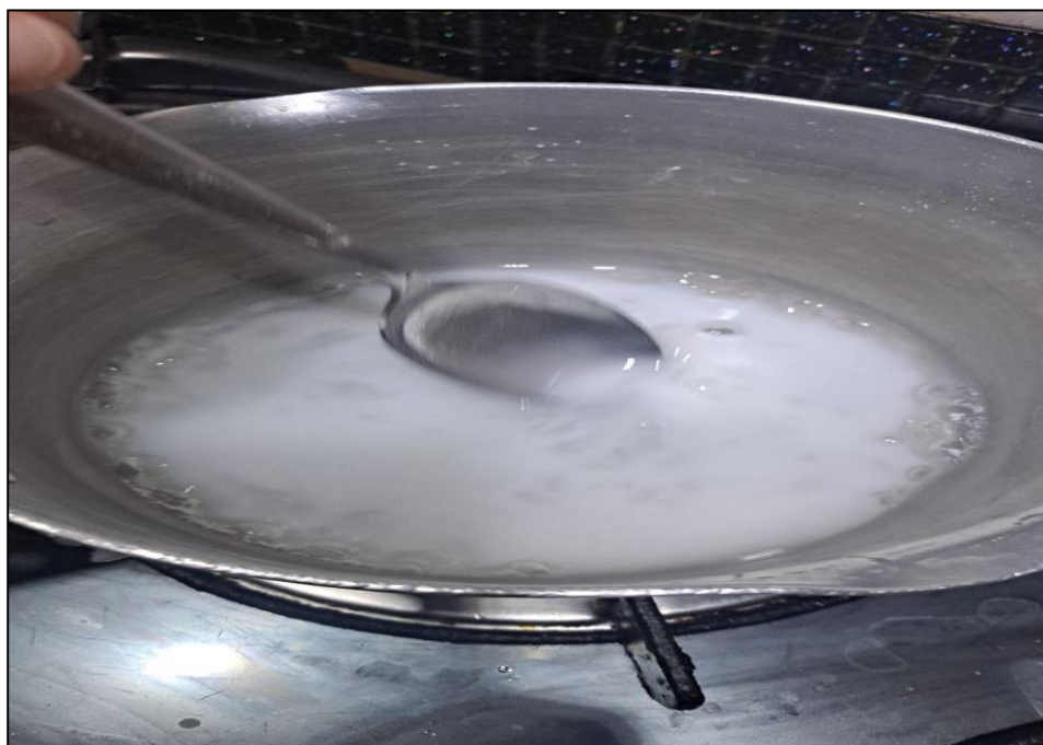
Photo IV.19 : Préparation et gélatinisation de l'amidon avec glycérol sous agitation chauffée.
