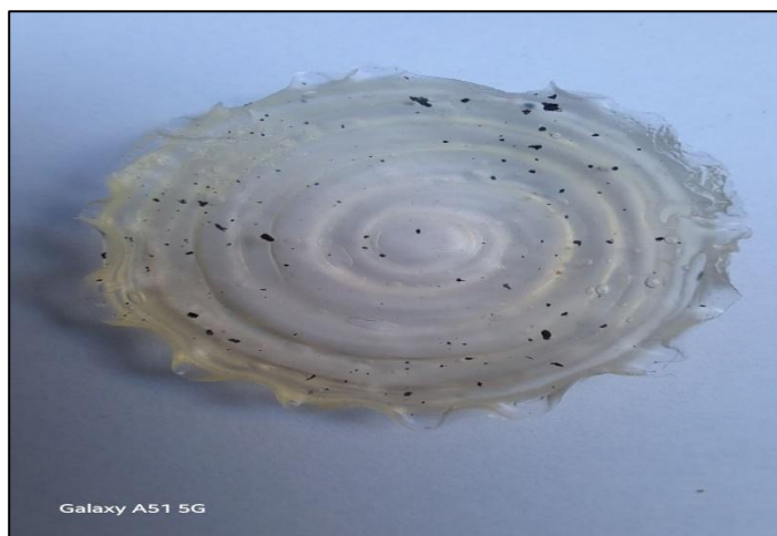
Photo V.22 : Film d'amidon modifié par NaOH présentant une surface translucide avec impuretés dispersées et bords irréguliers
