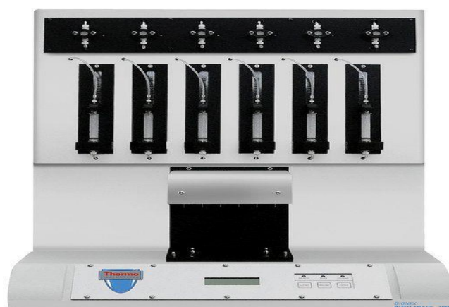
Figure 11 : système d'extraction par SPE automatisé 6 postes (AutoTrace SPE Caliper™) (Amalric, 2009)
