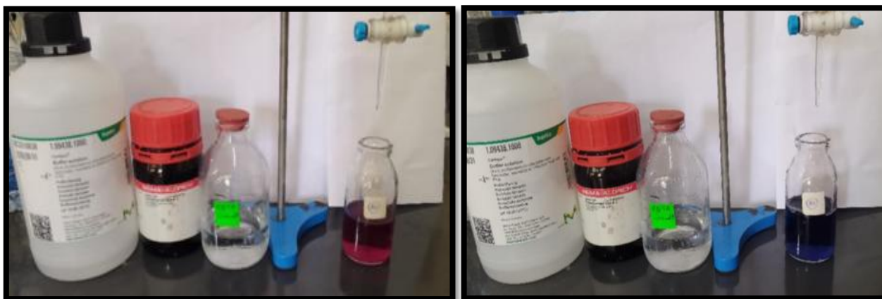
Figure 26 : Titrage de la dureté avant et après l'étalonnage d'ETDA.
