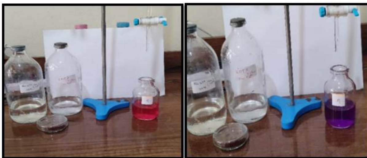
Figure 25: Dosage de calcium avant et après l'étalonnage d'EDTA.
