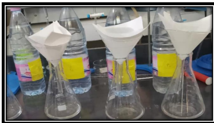
Figure 16 : filtration de l'eau à partir du papier filtre.
