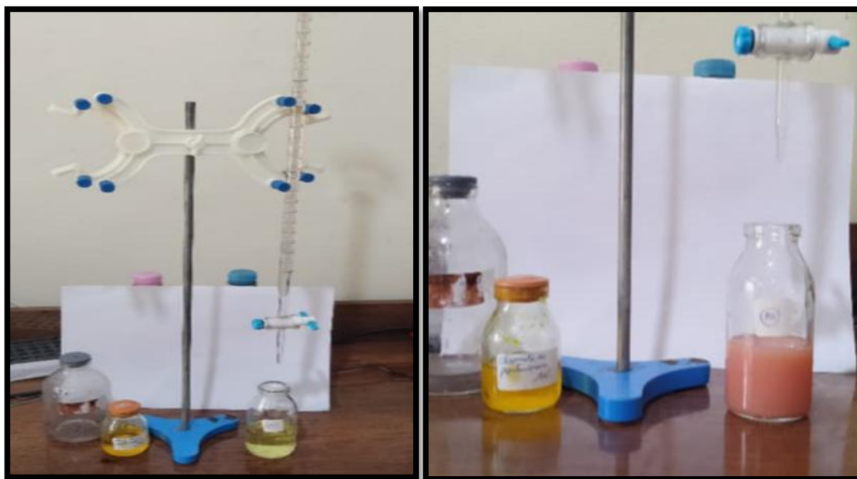
Figure 24: Dosage des chlorures avant et après l'étalonnage de nitrate d'argent.
