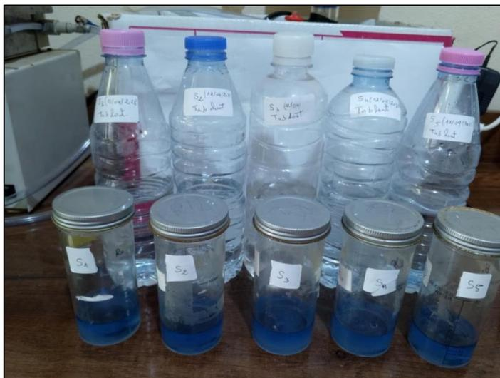
**Figure 46:** Dosage de silicium ( $\text{Si(OH)}_4$ ) (Photo originale).
