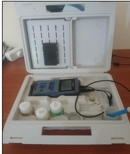
**Figure 39** : Appareil de mesure du pH (pH mètre Ph3110). (photo Original, 2025).
