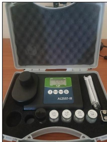
**Figure 40** : Appareil de mesure du Turbidité (Turbidimètre AL255T-IR)
