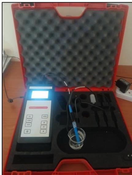
**Figure 41** : Appareil de mesure de la conductivité et TDS et salinité (**Multi-paramètres**).
