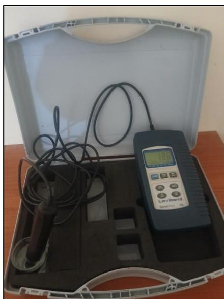
**Figure 42** : Appareil de mesure de l'oxygène dissous (**Oxymètre SensoDirect 150**)
