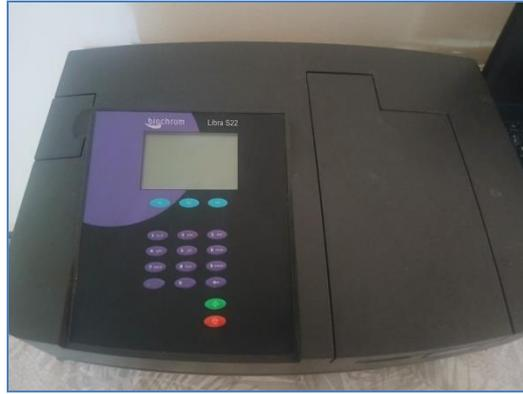
**Figure 43 :** Appareil de mesure de l'absorbance d'une solution homogène (Spectrophotomètre Libra S22) (Photo Original, 2025).
