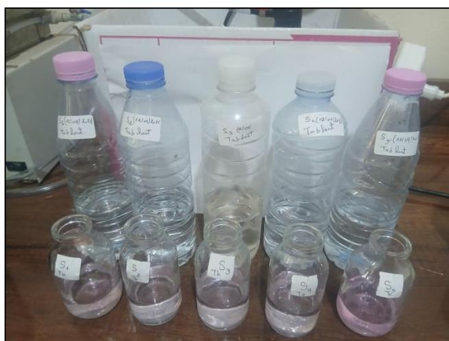
**Figure 47** : dosage des nitrites ( $\text{NO}_2$ ) (Photo originale)
