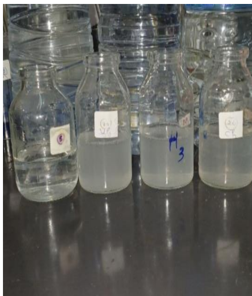
Figure 21 : Dosage de sulfate.
