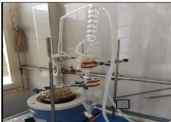
Figure 11 : Montage d'hydrodistillation (Clévenger).
