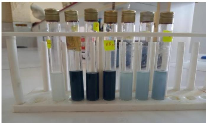
**Figure 04 :** Préparation de la gamme d'étalonnage de l'acide gallique.
