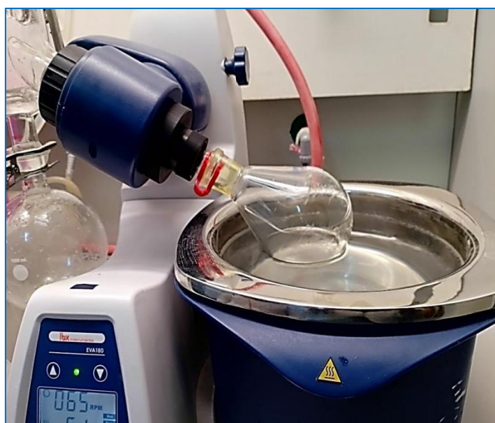
Figure 27 : Technique d'évaporation sous vide par évaporateur rotatif
