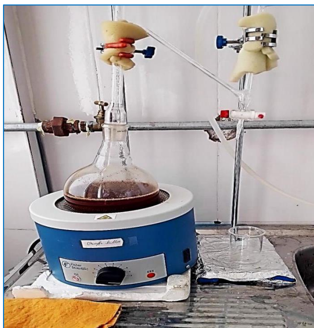
Figure 26 : Hydrodistillation par Clevenger (original)
