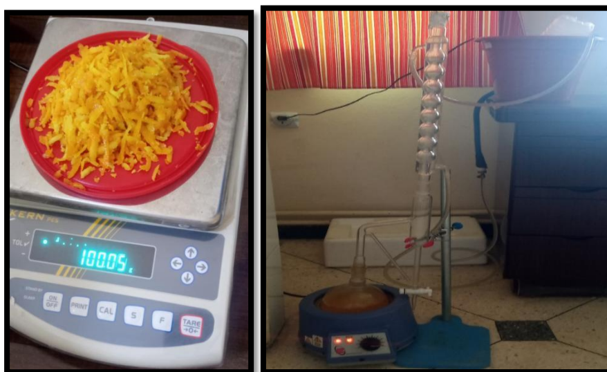
Figure 14: Appareil de distillation hydrique de type Clevenger, ( Photo personnelle, 2025 ).
