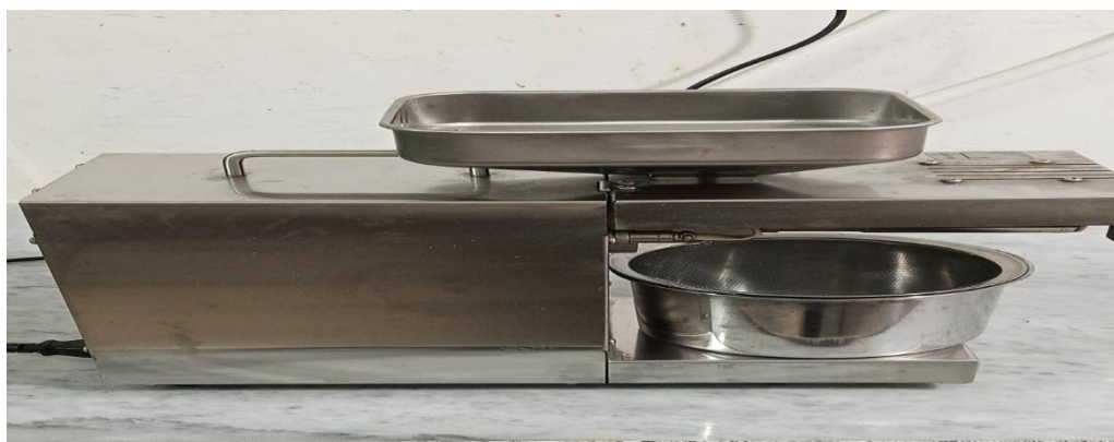
Figure19 : Presse mécanique utilisée pour l'extraction à froid des huiles des graines de Lepidium sativum et Lagenaria siceraria .
