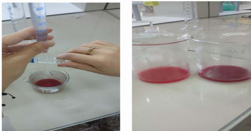
Figure 23 : Changement de couleur à l'équivalence lors du titrage par NaOH (photographie personnelle ;2025)
