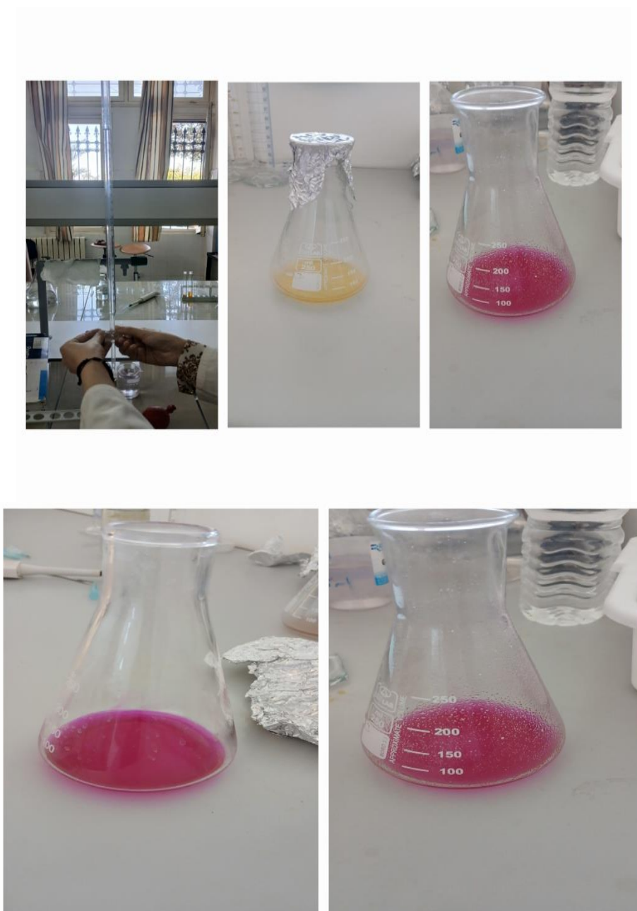
Figure 24 : Titrage de l'excès de KOH (0,5N HCL) en présence de phénolphtaléine photographie personnelle ; 2025).
