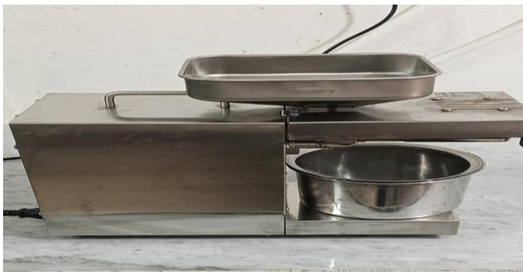
Presse mécanique utilisée pour l'extraction à froid des huiles des graines de Lepidium sativum et Lagenaria siceraria
