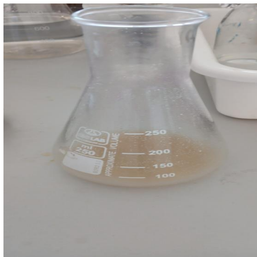
Figure 25 : Fin du titrage marquée par la disparition de la coloration rose (Phénolphtaléine) photographie personnelle ; 2025).
