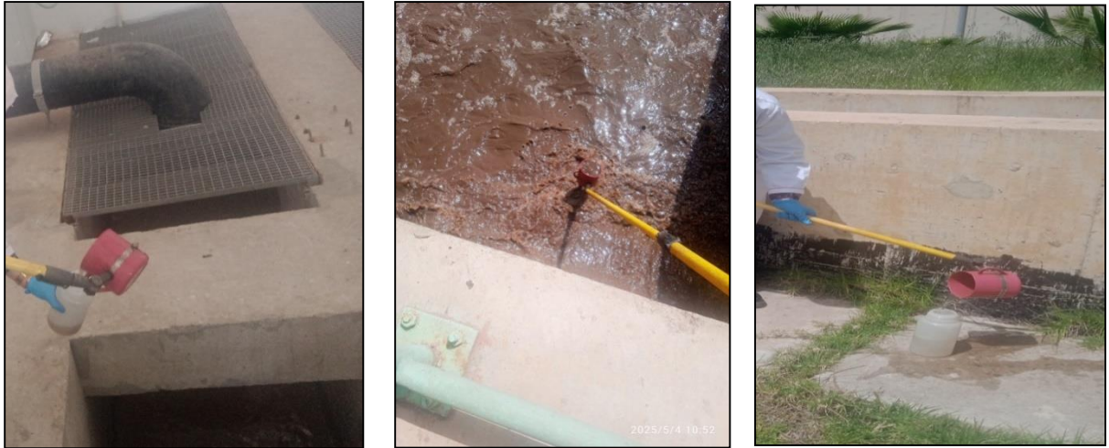
a. point n°1 (l'eau brute) b. point n°2 (la boue activée) c. point n°3 (l'eau épurée)
