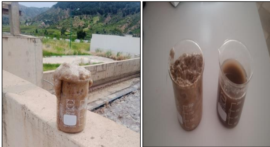
Figure 50 : Aspect de deux échantillons de mousse flottante et de boue activée (STEP Ferdjioua).
