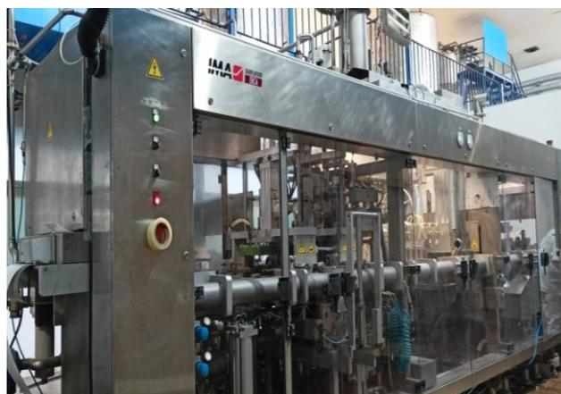
**Figure 13 :** Conditionneuse « ERCA » (Photo personnel, 2025).
