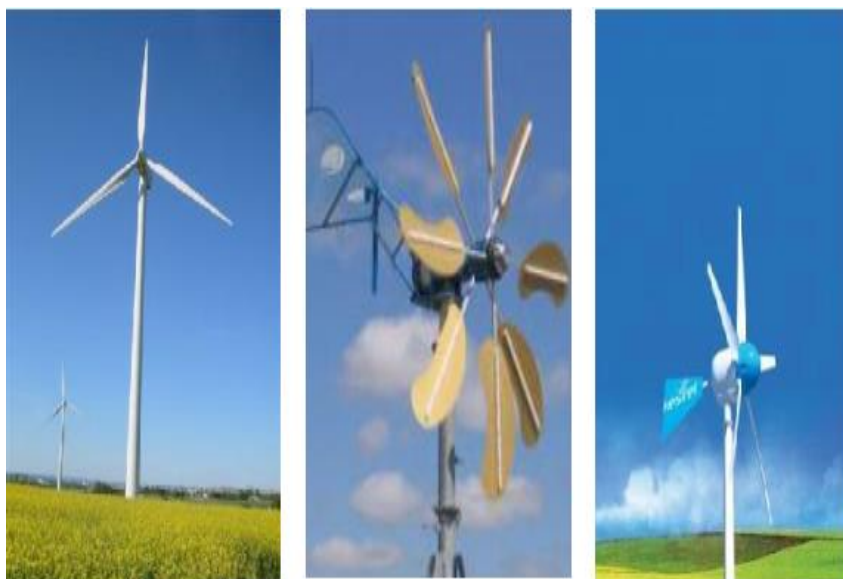
FigureVI-3 Eolienne à axe horizontal.
