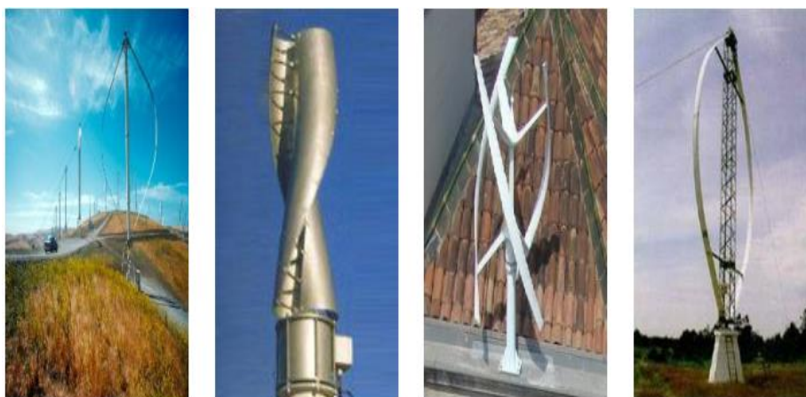
Figure VI.2 Éolienne à axe vertical.
