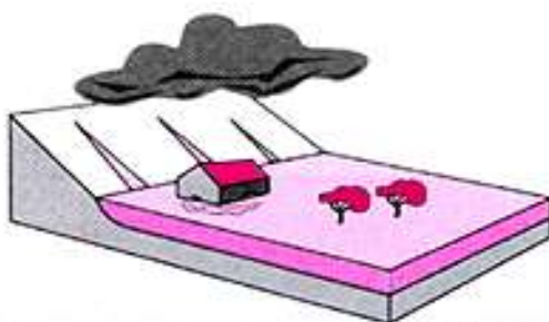
Figure 8 : Inondation par stagnation d'eau pluviale
