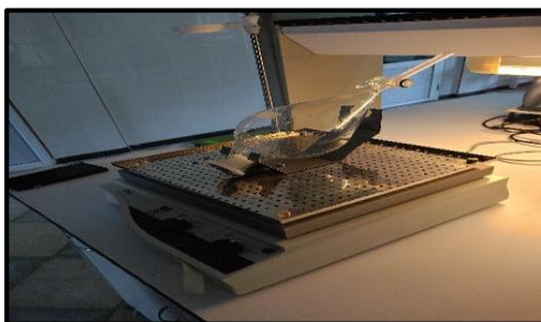
Figure 54 : Evaporateur par Vibration.
