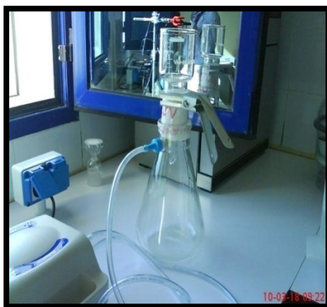
Fig.20 : Détermination de la MES des eaux épurées par filtration.
