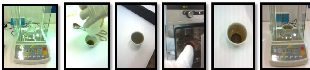
Fig.19: Détermination de la MES des eaux brutes par centrifugation.
