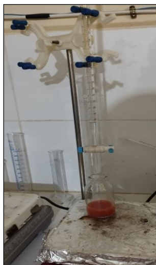
Figure 37 : Dosage De Chlorure (Cl) (Photo originale).
