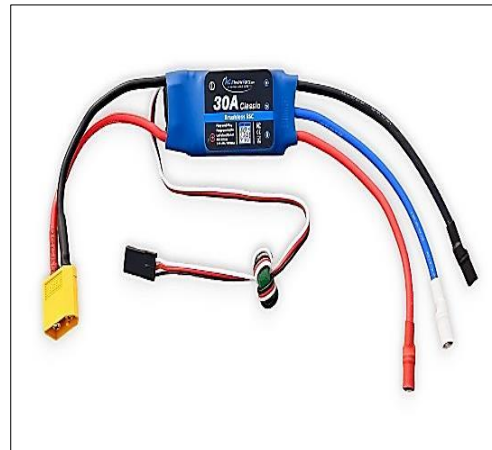
Figure IV.3 : Contrôle de Vitesse 30A ( https://www.ebay.com/itm/395165961067 )
