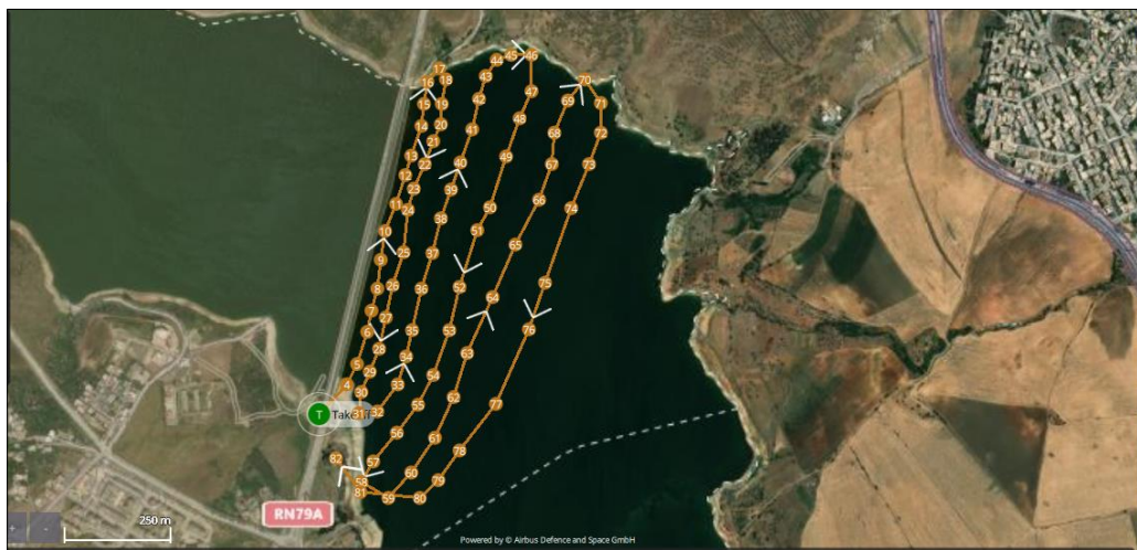
Figure 4 Exemple de planification des itinéraires de vol dans le réservoir du barrage de Beni haroun avec QGroundControl.
