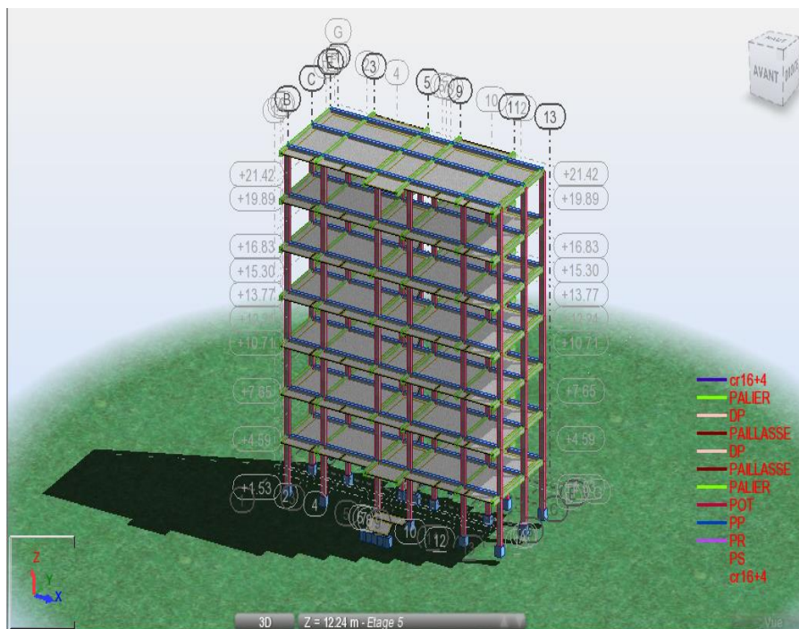
Figure VI.2: Modèle numérique de la structure à (R+6).
