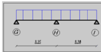
Figure III. 22: Schéma de poutrelle (02 travée).
