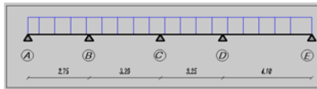
Figure III. 21: Schéma de poutrelle (04 travée).
