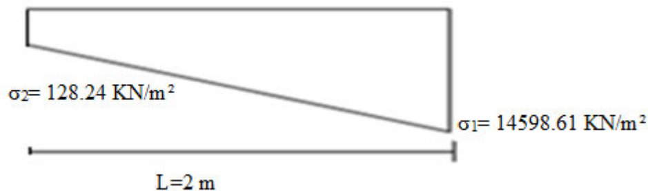
Figure V.8 : Schéma de distribution des contraintes (Voile transversal).
