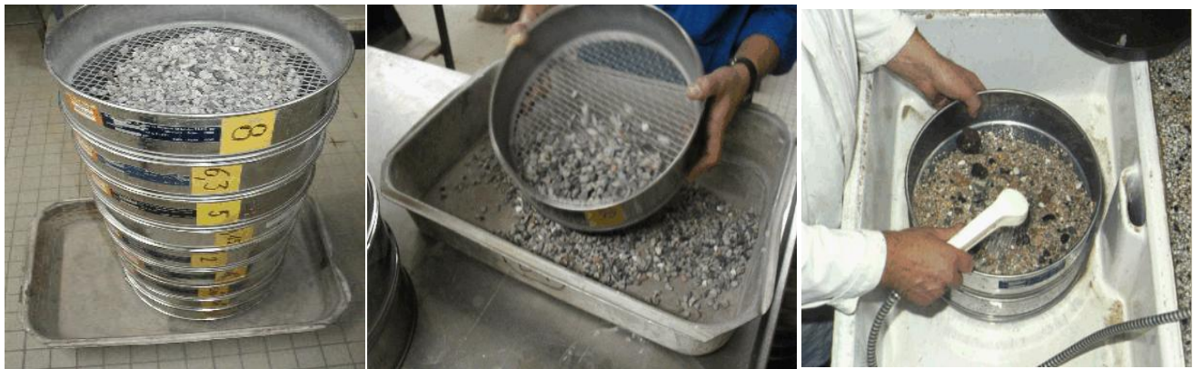
Figure. II.10. Les étapes de l'analyse granulométrique
