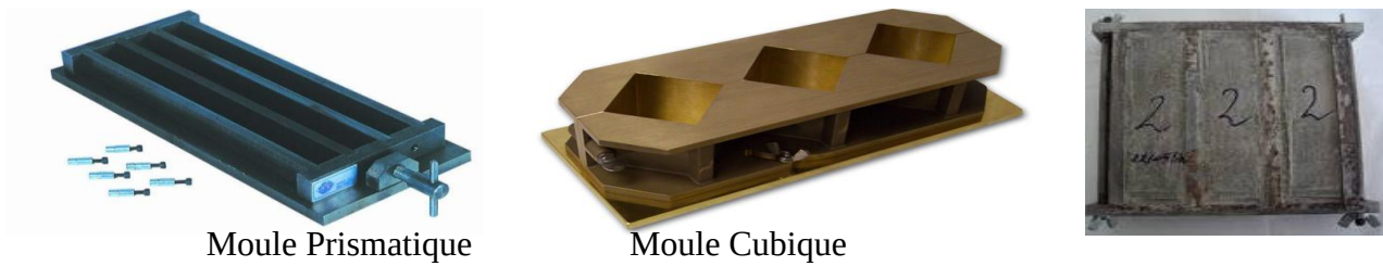
Figure. IV.4. Moule pour moulage des éprouvettes de mortier
