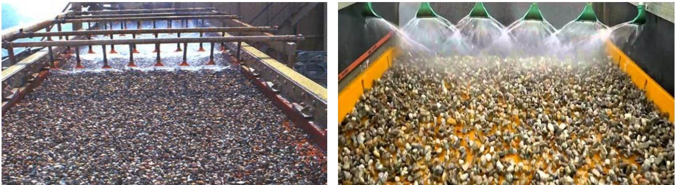
Figure. II.7. Procédure de lavage des granulats
