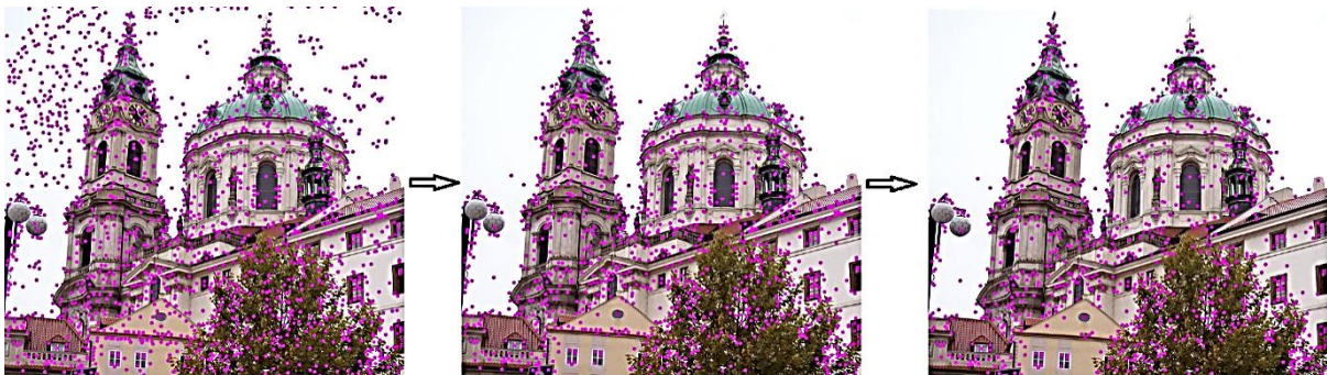
Figure 4.5 : élimination des points d'intérêt de faible contraste et qui se trouvent sur des contours.
