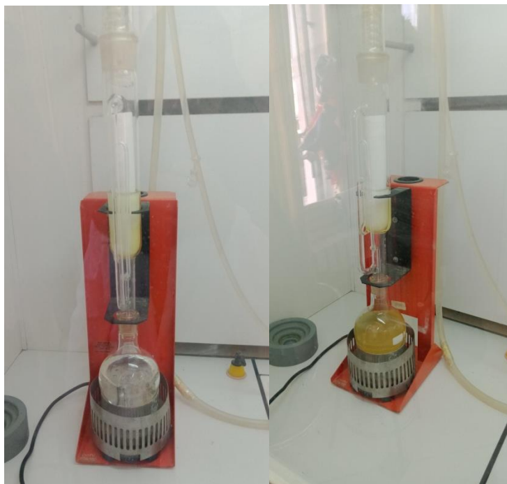
Figure 11 : A/ avant l'extraction par soxhlet ; B/après l'extraction par soxhlet
