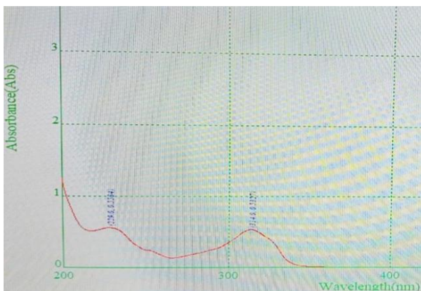
Figure II-6 : Spectre d'absorption UV-visible de MBT (10 mg /l) dans l' eau .
