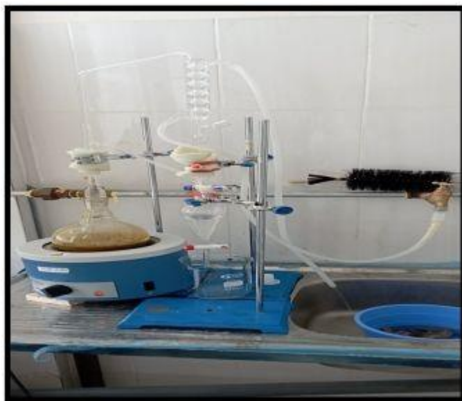
Figure 09 : Montage d'hydrodistillation (Clévenger).
