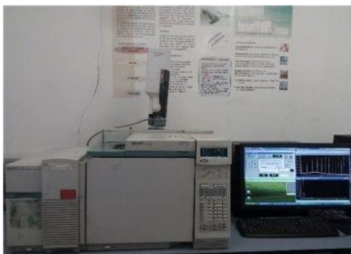
Figure 10 : Chromatographe à phase gazeuse ( Hewlett Packard Agilent 6890 ) couple à un spectromètre de masse ( Hewlett Packard Agilent 5973 ).
