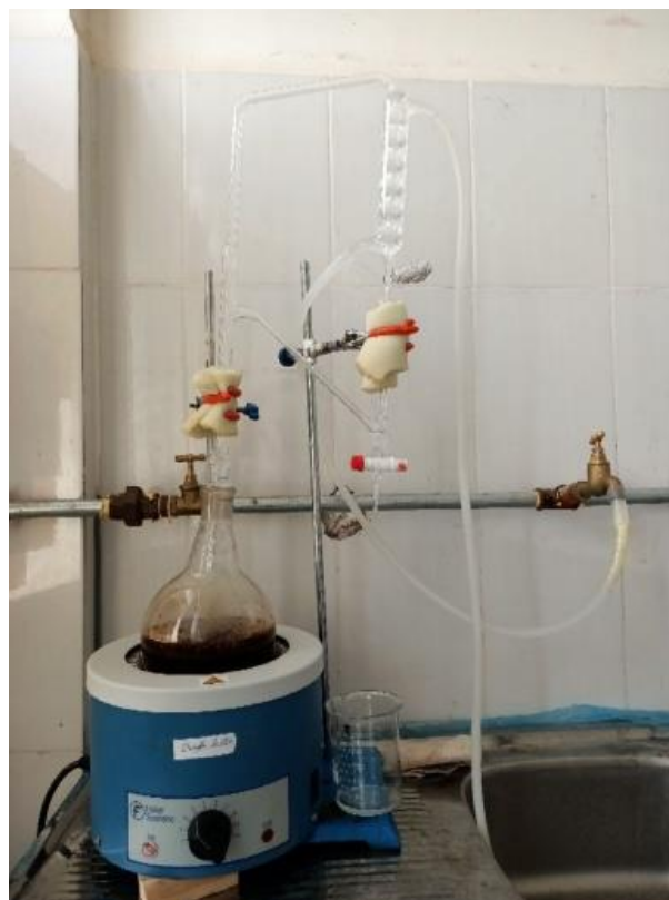
Figure 10 : Extraction de l'huile essentielle par l'appareil de type Clevenger (Photo personnelle).
