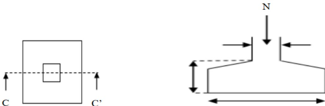
Figure V.2: Schéma de la semelle isolée.
