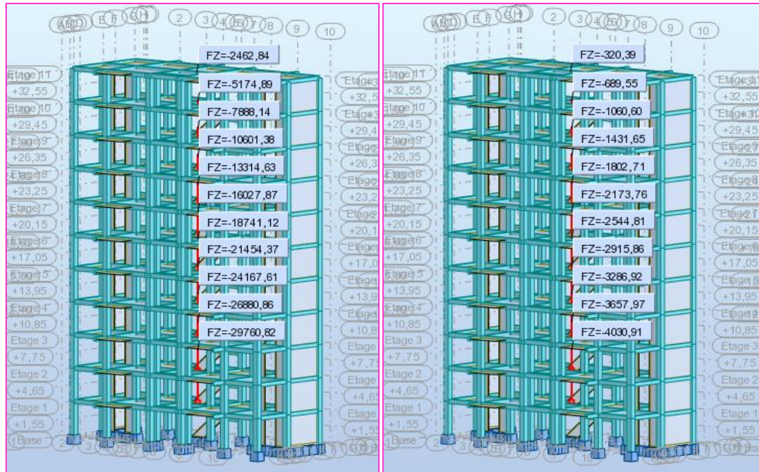
Figure IV.75: Poids total de la structure cas10E-ZIII.
