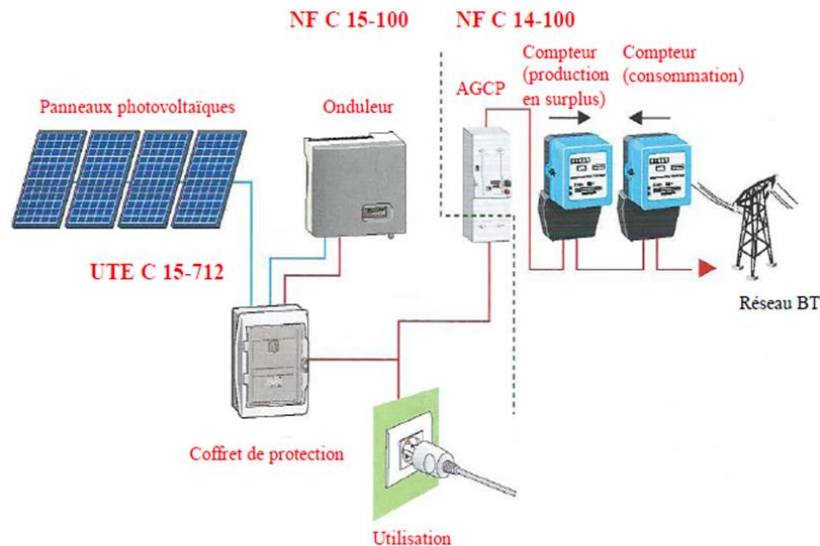
Figure III.22 : Injection énergie supplément dans le réseau
