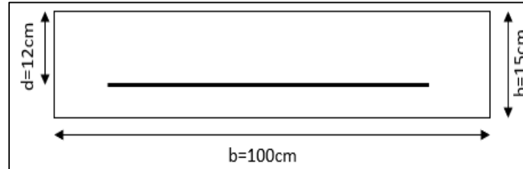
Figure III.8. Section équivalente de calcul d'escalier.
