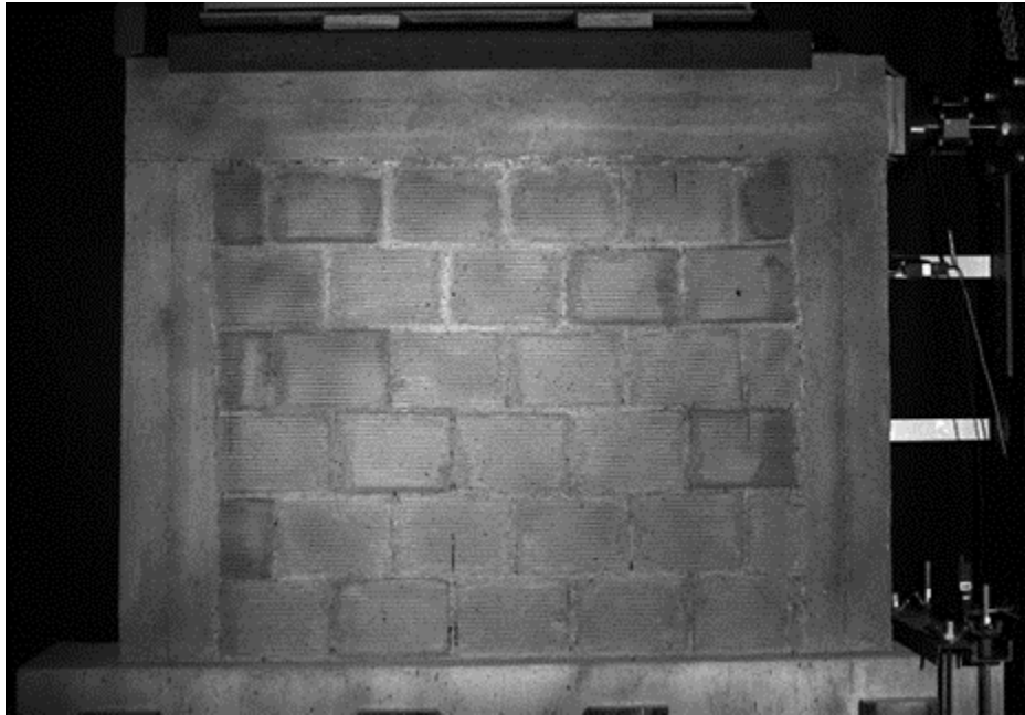
Fig. II.9 : Test sur le spécimen PR1 (chargement monotone-panneau rempli).
