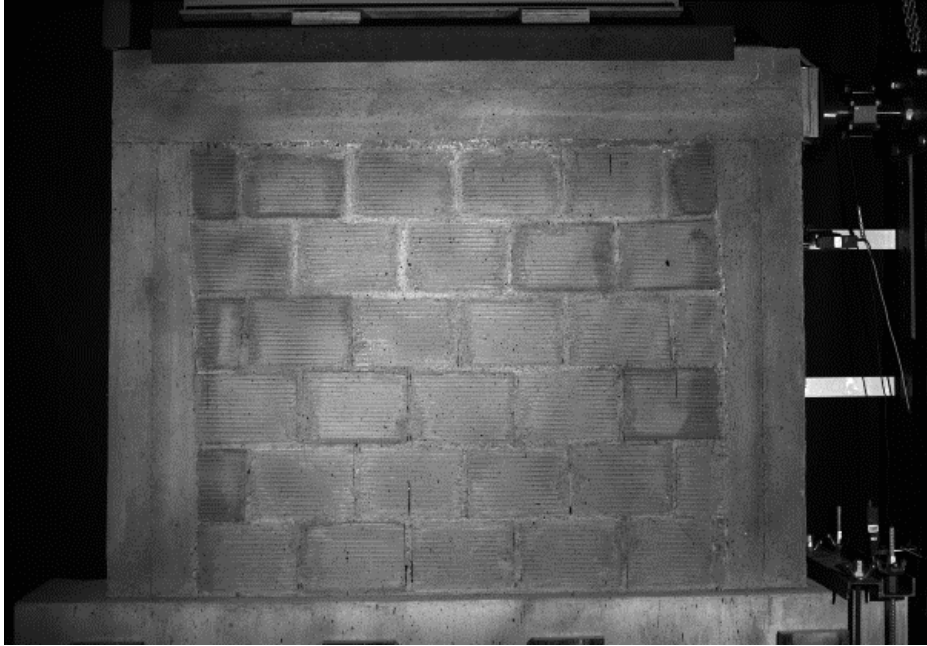
Fig. II.3 : Test sur le spécimen PC2 (chargement cyclique-panneau uniforme).
