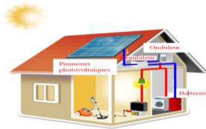
Figure I.12 : Installation sur site isolé.
