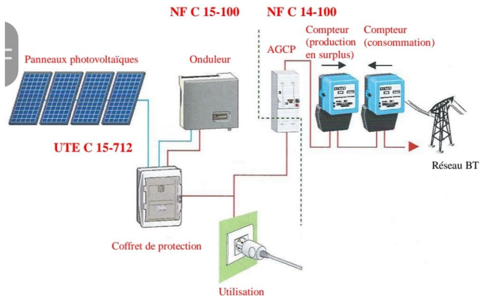
Figure I.16 : Injection d'énergie supplément dans le réseau.
