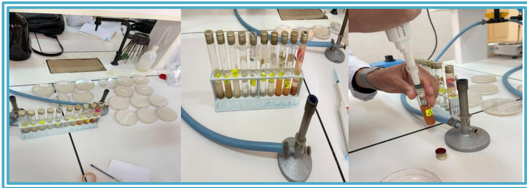
Figure 13 : Les étapes de d'ensemencement des échantillons.
