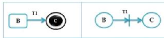
FIG. 5.17 : Transformation d'une transition d'un état final.
