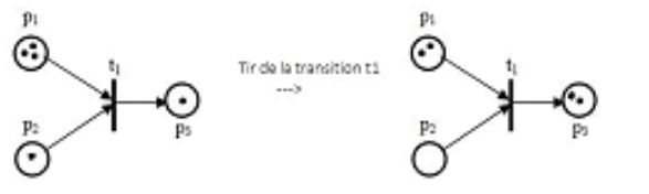
FIG. 3.8 : franchissement d'un Rdp.
