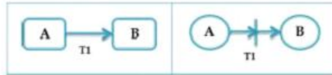
FIG. 5.9 : Transformation d'une transition simple.
