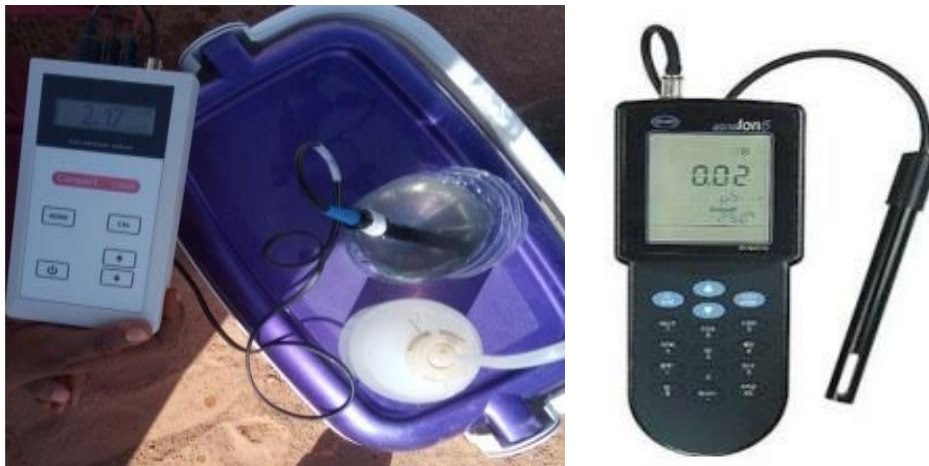
Figure IV.6 : La mesure de la conductivité
