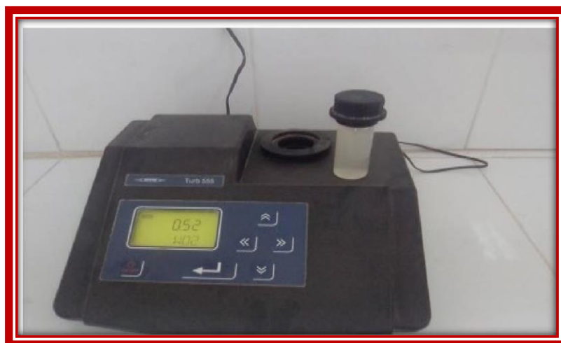
Figure IV .10: La mesure de la turbidité
