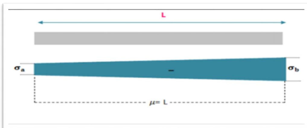
Figure V.9 : Section entièrement tendue
