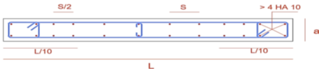
Figure V.2 – Disposition des armatures verticales dans les voiles
