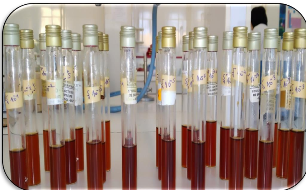
Figure 70: Dénombrement des streptocoques fécaux des eaux de la STEP de Ferdjioua (Cliché personnel, Mai 2021).
