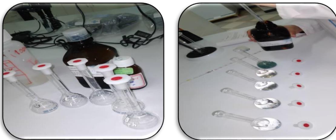
(a) les réactifs de phosphate utilisés. (b) L'apparition de la coloration bleue.
