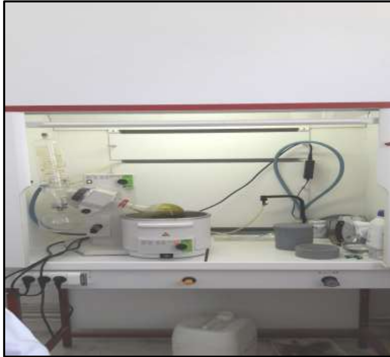
Figure 34: Evaporateur rotatif dans le laboratoire (Photo personnelle).
